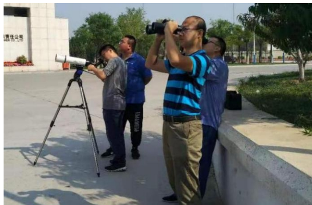
图4 使用不同类型的林格曼望远镜观测烟气黑度
