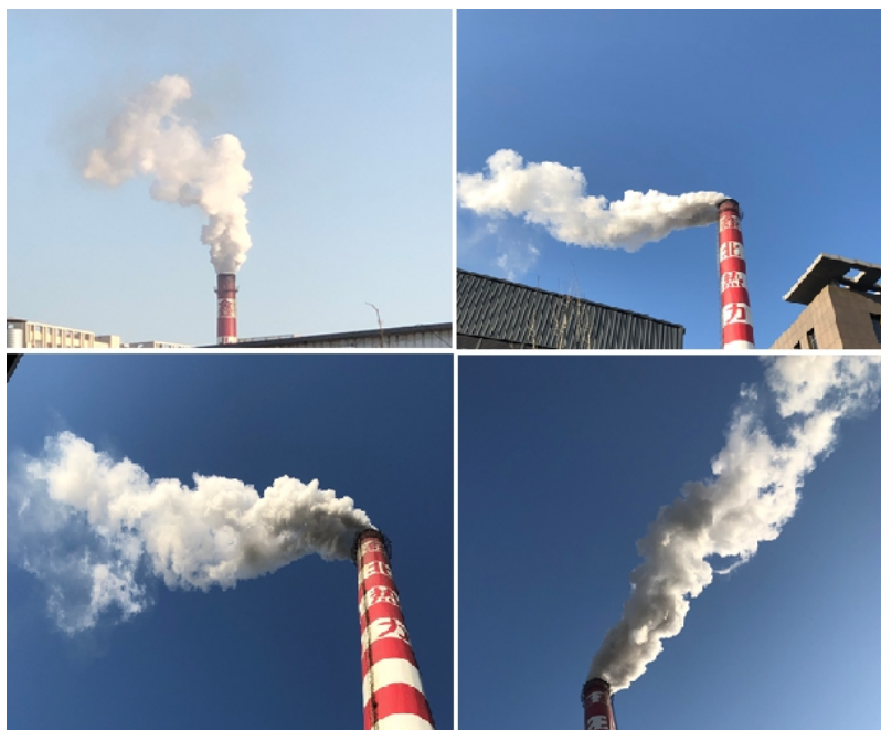
图7 不同观测角度对烟气黑度观测的影响
