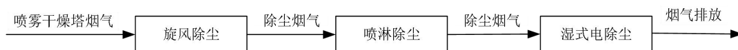
图 5-10 喷雾干燥塔烟气旋风除尘+喷淋除尘+湿式电除尘治理技术工艺流程图
