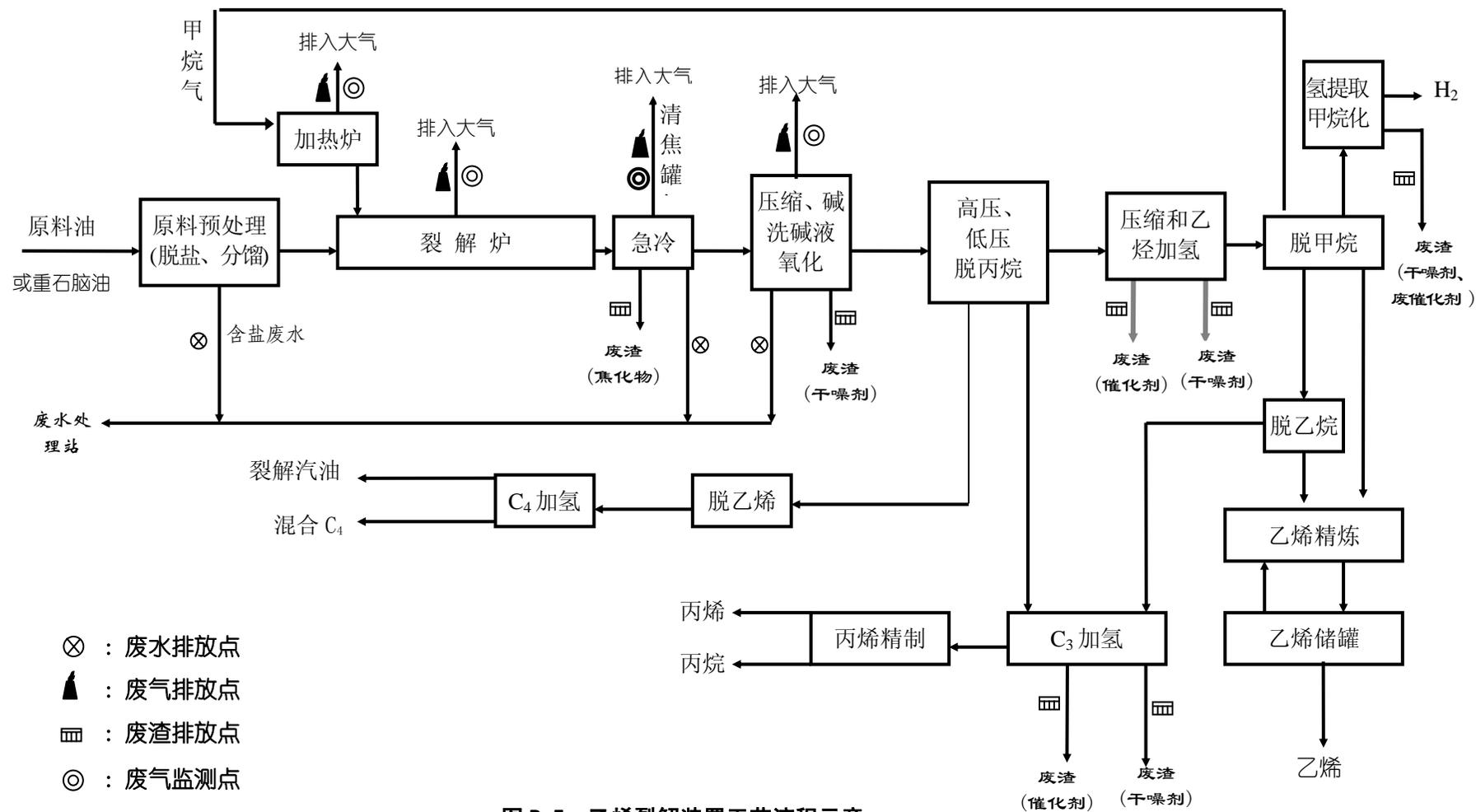
图 B.5 乙烯裂解装置工艺流程示意
