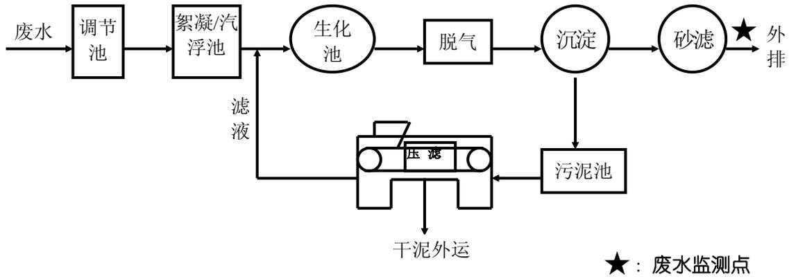
图 B.12 废水处理工艺流程
