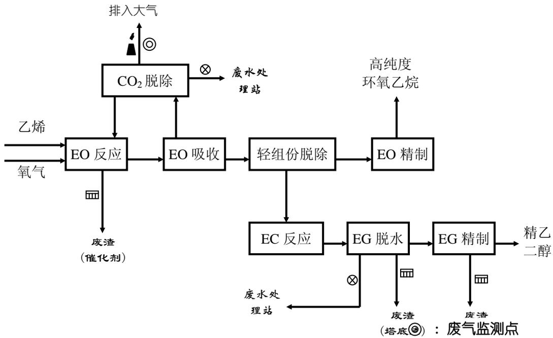
图 B.7 环氧乙烷/乙二醇装置工艺流程示意
