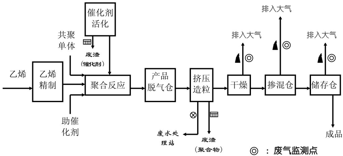
图 B.10 线性低密度/高密度聚乙烯装置工艺流程示意
