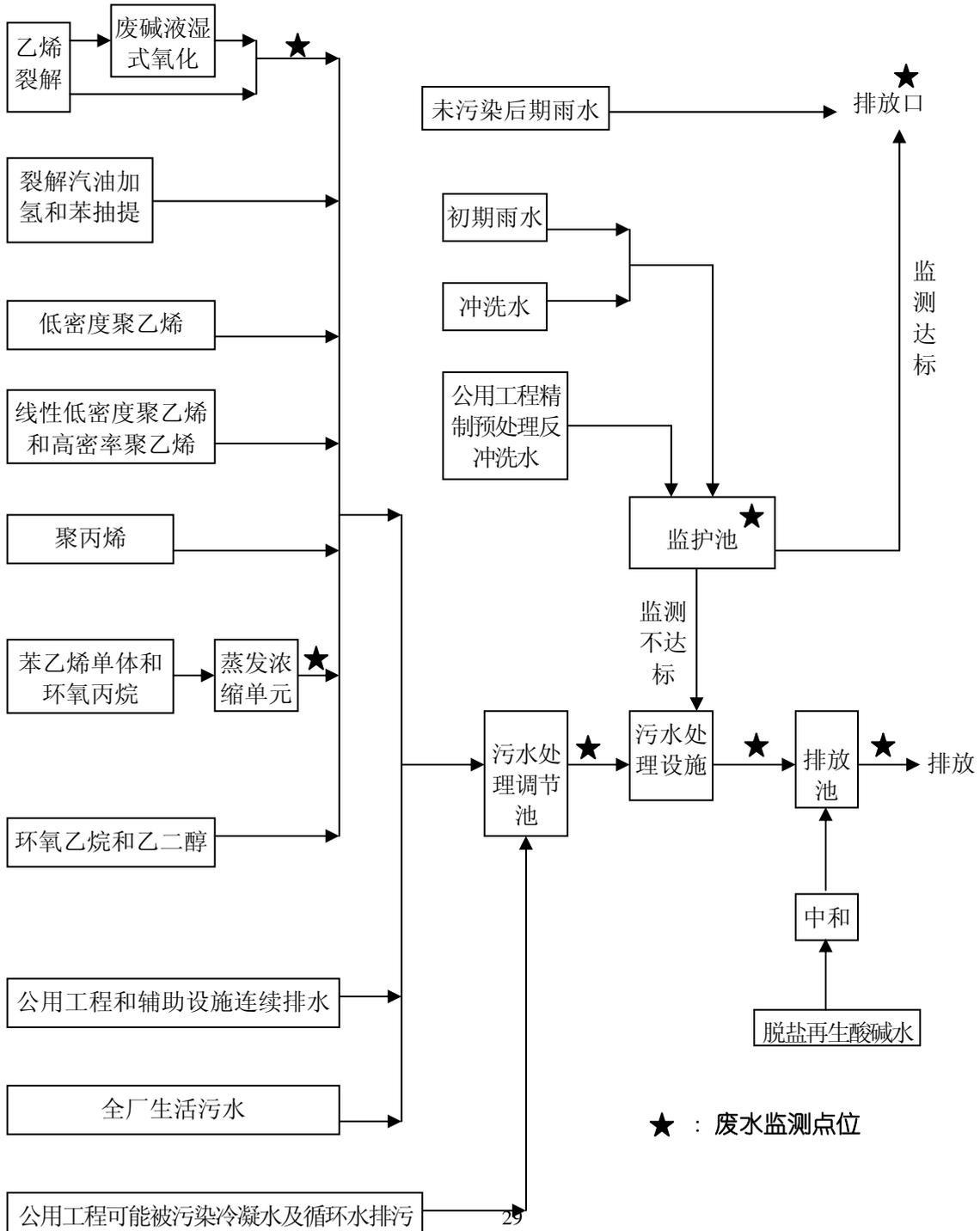
图 B.13 某厂废水排放走向及监测点位
