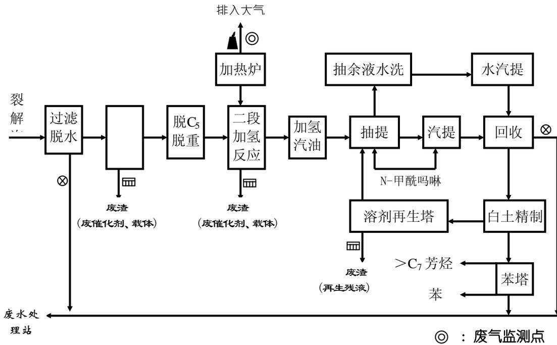
图 B.6 裂解汽油加氢/苯提装置工艺流程示意
