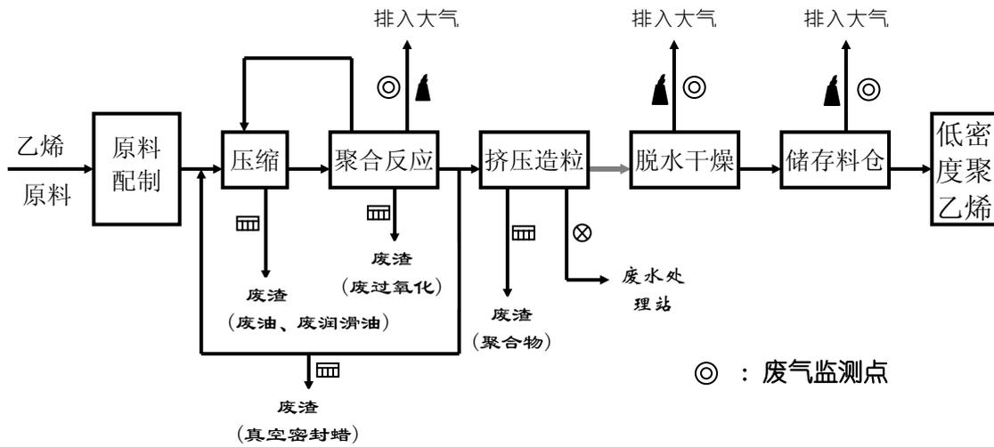
图 B.9 低密度聚乙烯装置工艺流程示意
