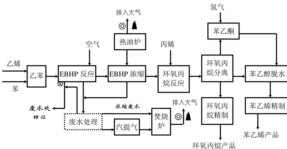
图 B.11 苯乙烯/环氧丙烷装置工艺流程示意
