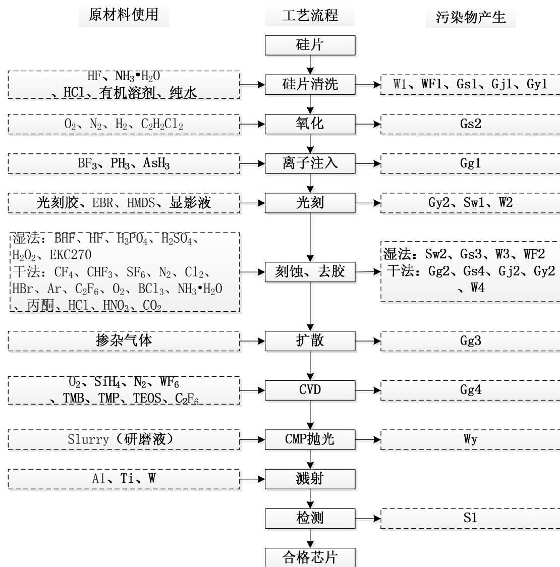
图 4-23 集成电路制造主要生产工序、材料消耗与污染物排放示意图
