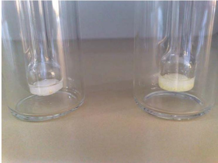
图 5-1 气泡吸收瓶采样后与采样前玻板对比
