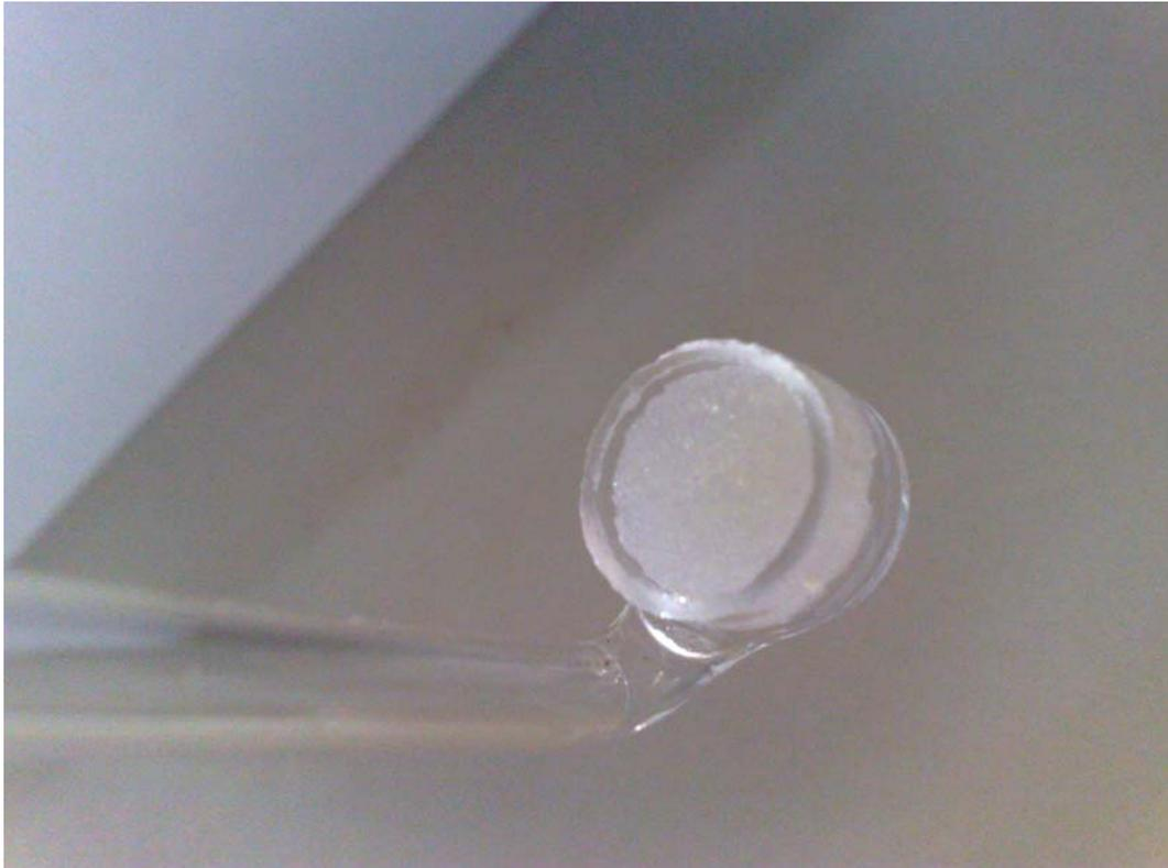
图 5-3 烟道气吸收瓶采样后玻板残留
