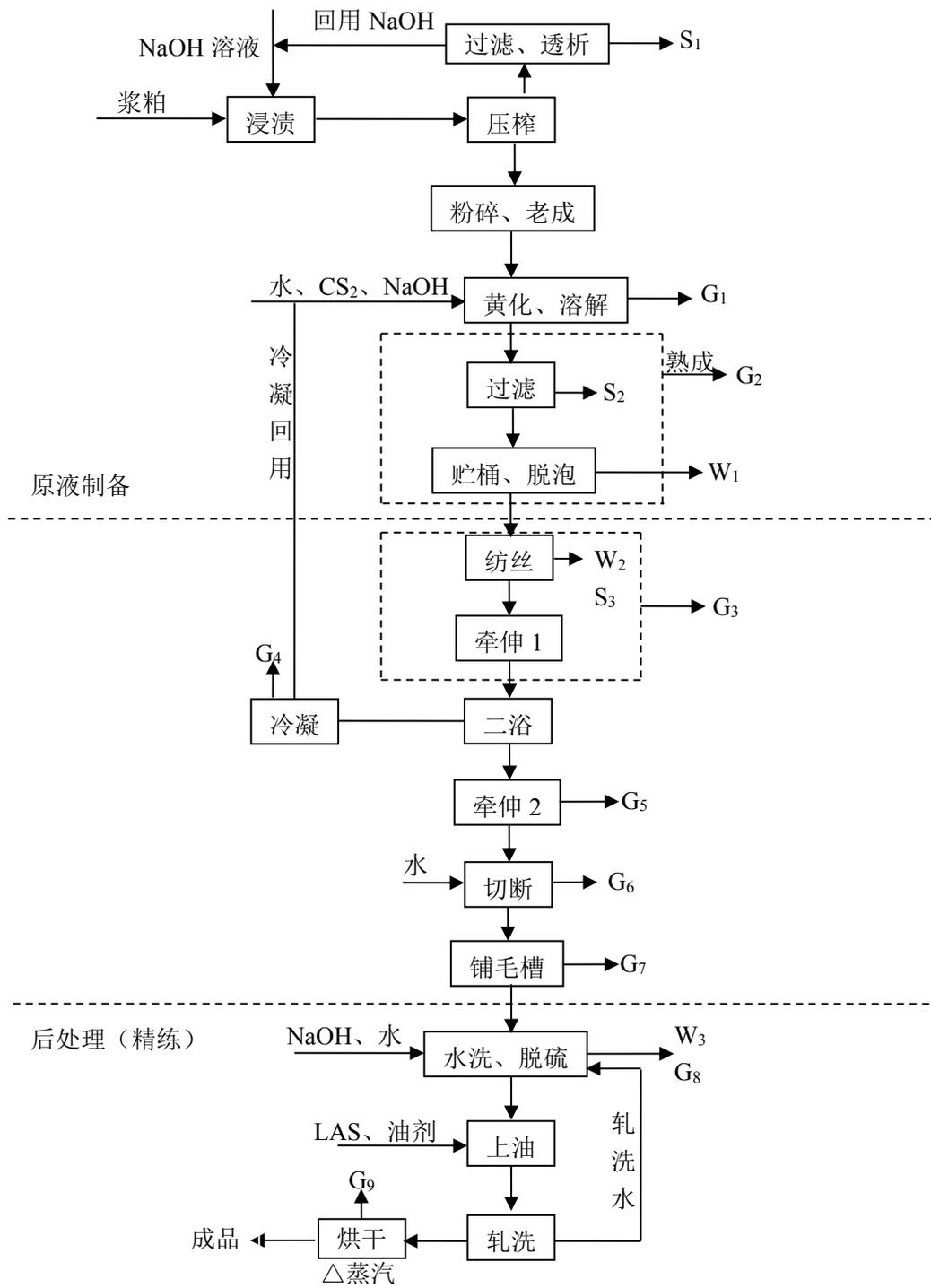
图 B.1 典型粘胶纤维项目工艺流程及产污环节示例图（粘胶短丝生产 单位：t/d）
