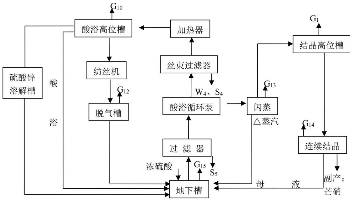
图 B.2 酸站工艺流程及产污环节图
