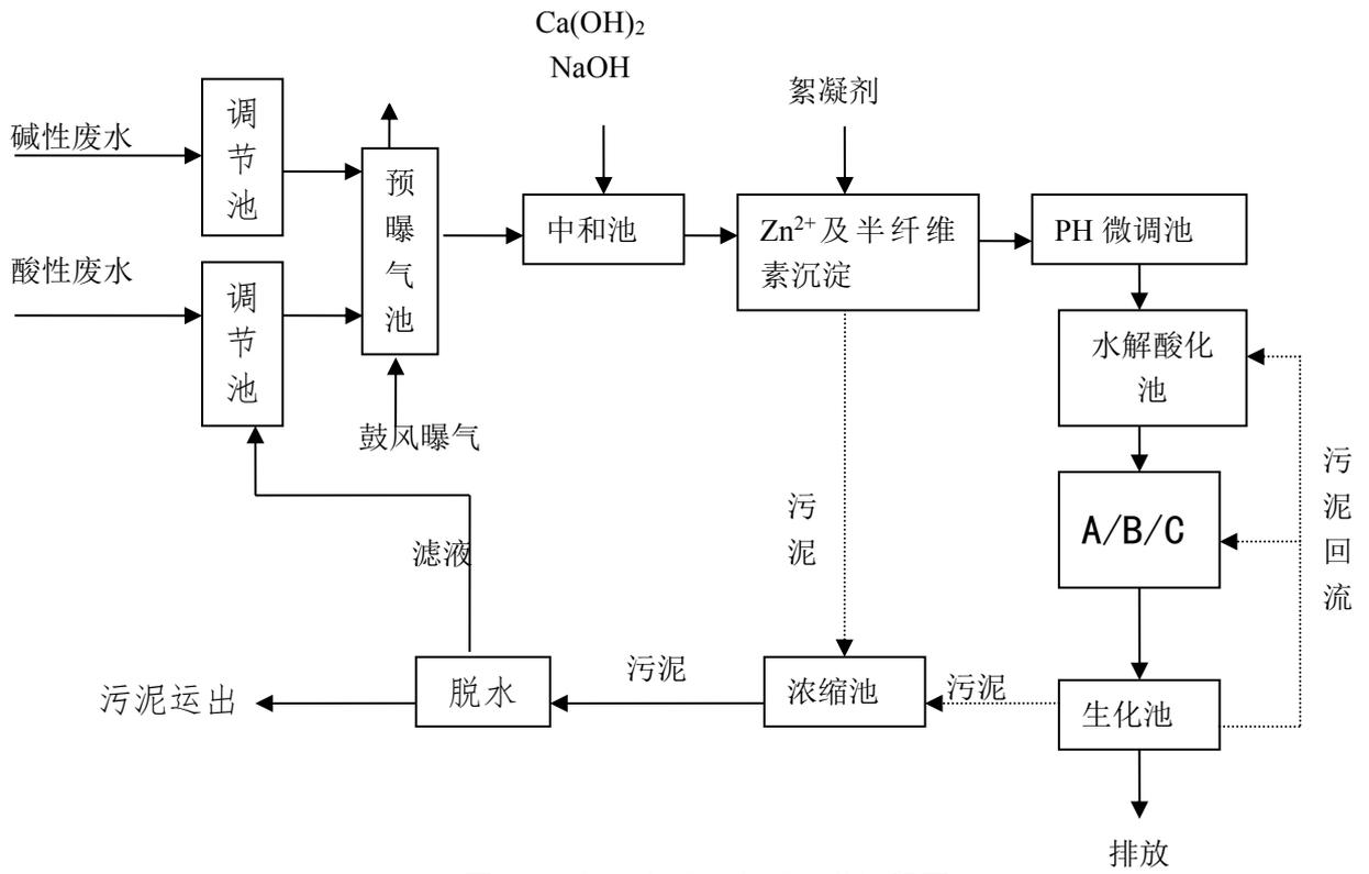
图 B.4 污水处理站处理工艺流程图
