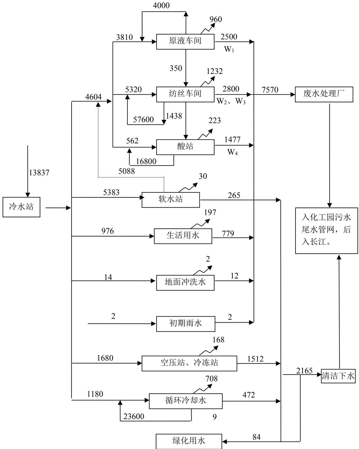
图 B.3 粘胶长丝水量平衡示例图 单位: (t/d)
