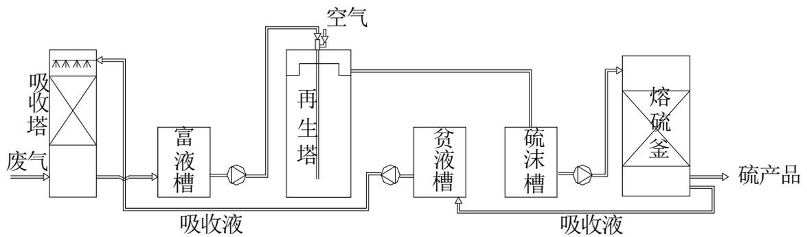
图 B.5 栲胶法脱硫工艺流程图
