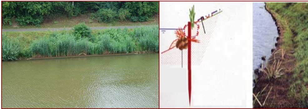
图 4.7 下直上斜式护岸结构示意图
