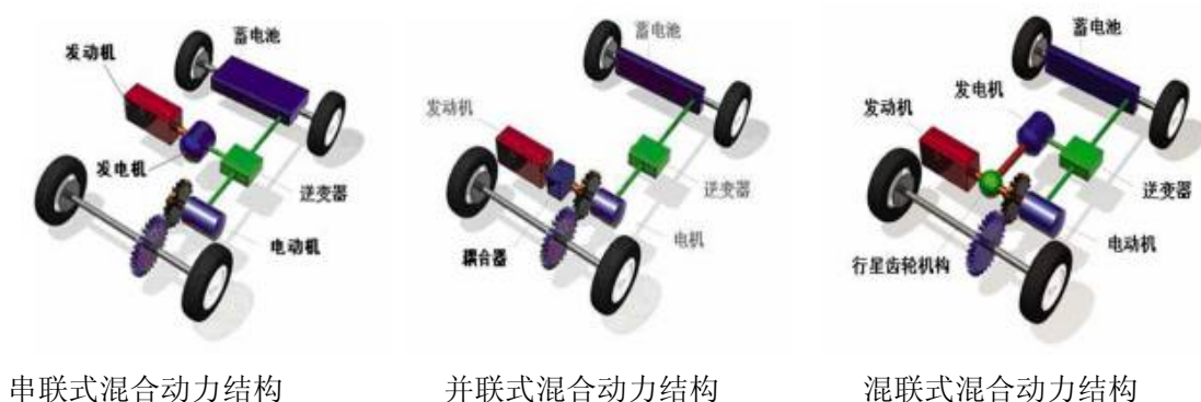
图 1 典型的混合动力结构原理示意图
