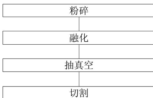
图1 一次性注射器的再生利用程序
