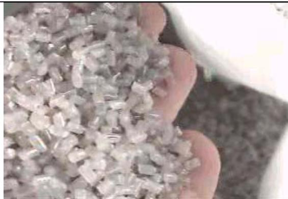
图 7 应用于再生利用原料的废塑胶方块
