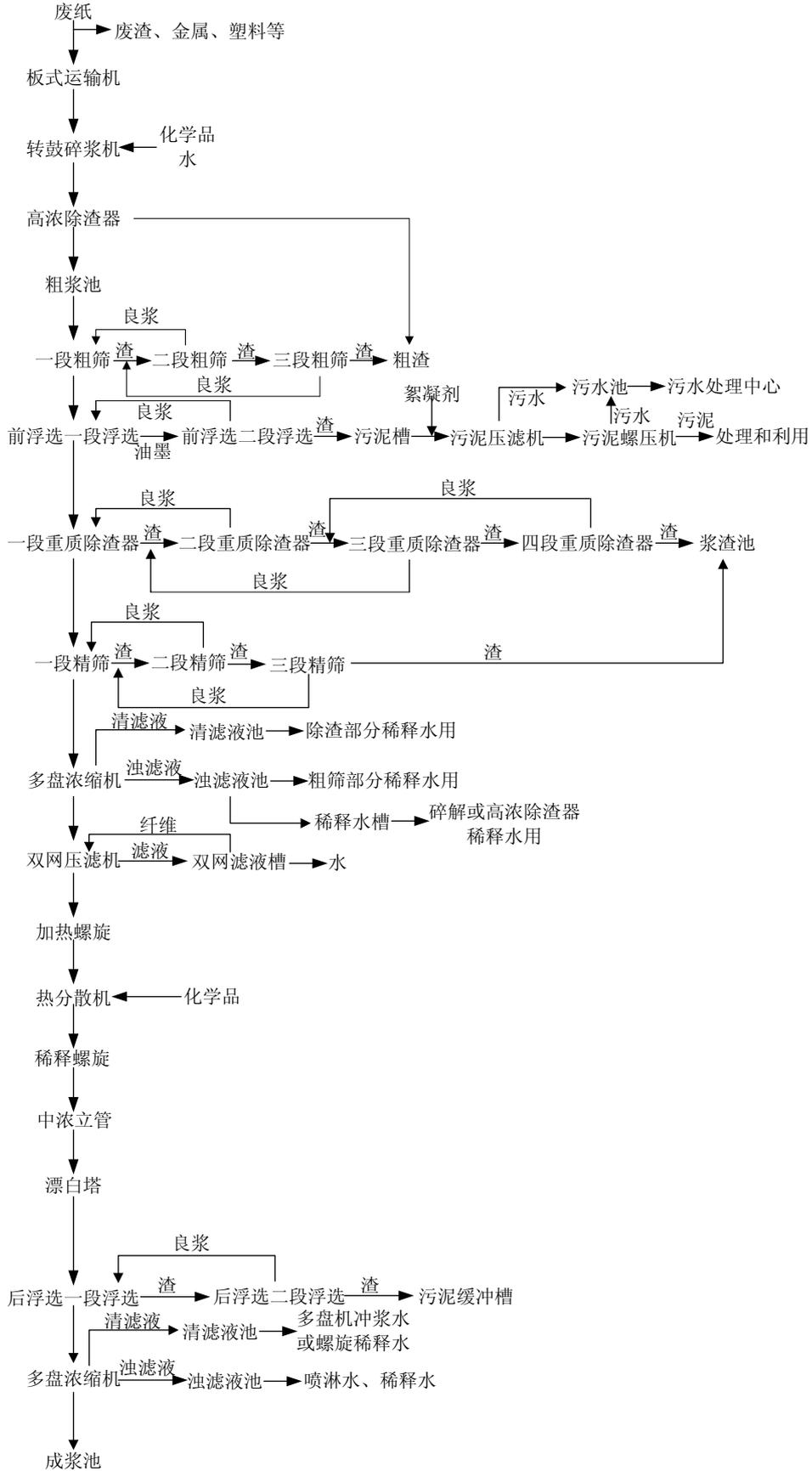
图 A.1 废纸制浆各工段工艺过程物流图
