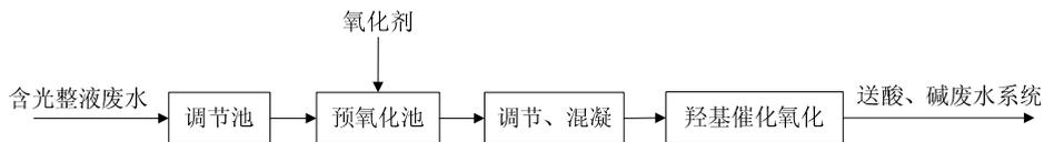
图 4-17 催化氧化法预处理含光整液废水工艺流程示意图
