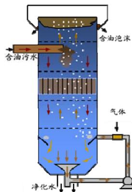
图1 除油型旋流静态微泡浮选柱
