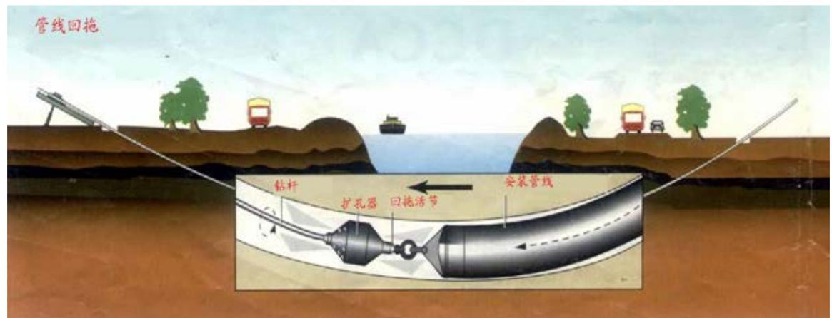
图 3.1-7 管线回拖示意图
