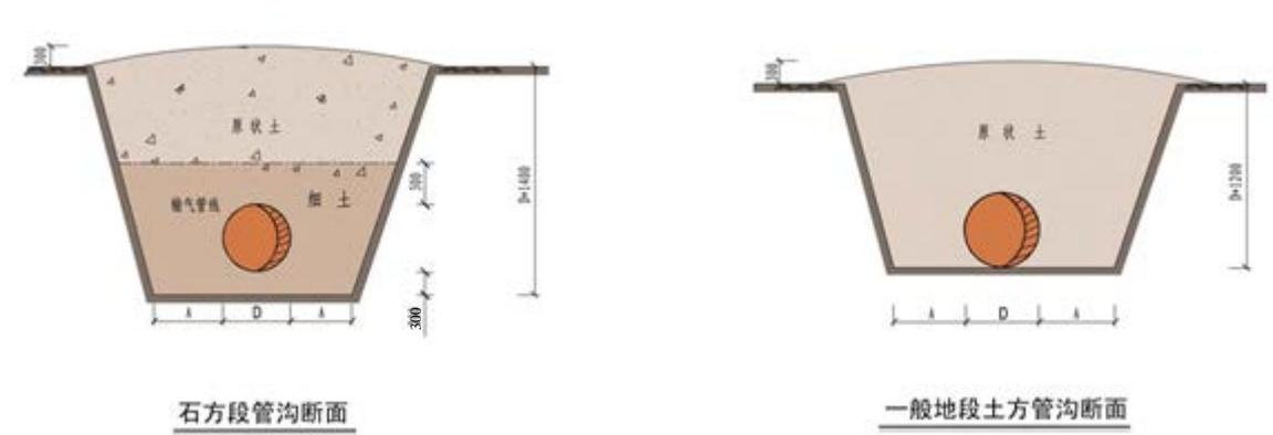
图 2.6-1 不同地段管沟断面示意
