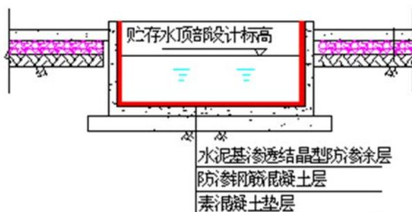
图 9.3-7 污水池、污水井防渗层结构图
