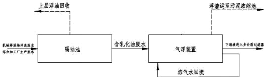
图 6.2.1-7 宗通卡水利枢纽工程含油废水处理工艺流程图
