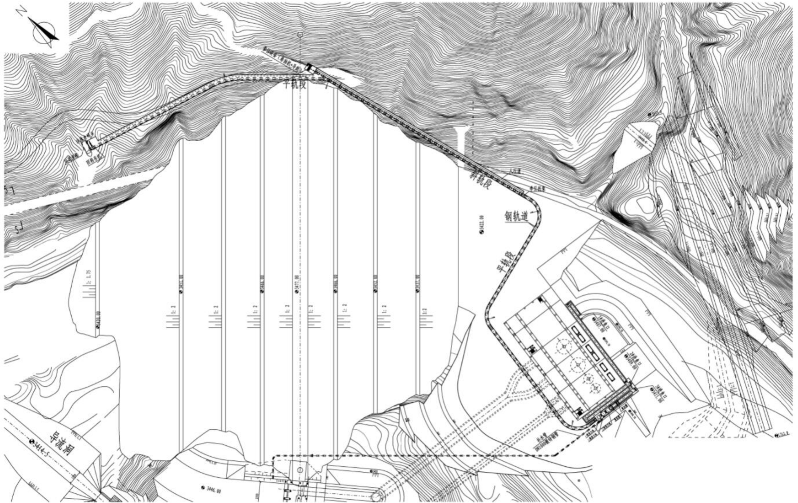
附图9 西藏昂曲宗通卡水利枢纽工程短鱼道+升鱼机组合方案布置图（推荐方案）
