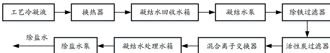
图 4.4-3 工艺凝结水制除盐水流程图
