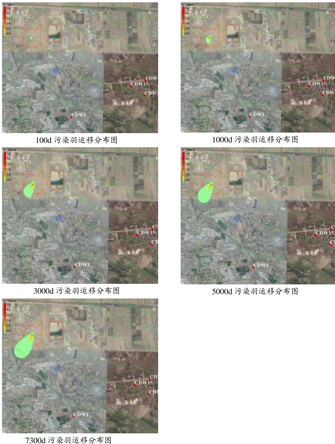
图 6.4-42 渣场防渗层破损污染物氟化物在潜水含水层迁移预测图
