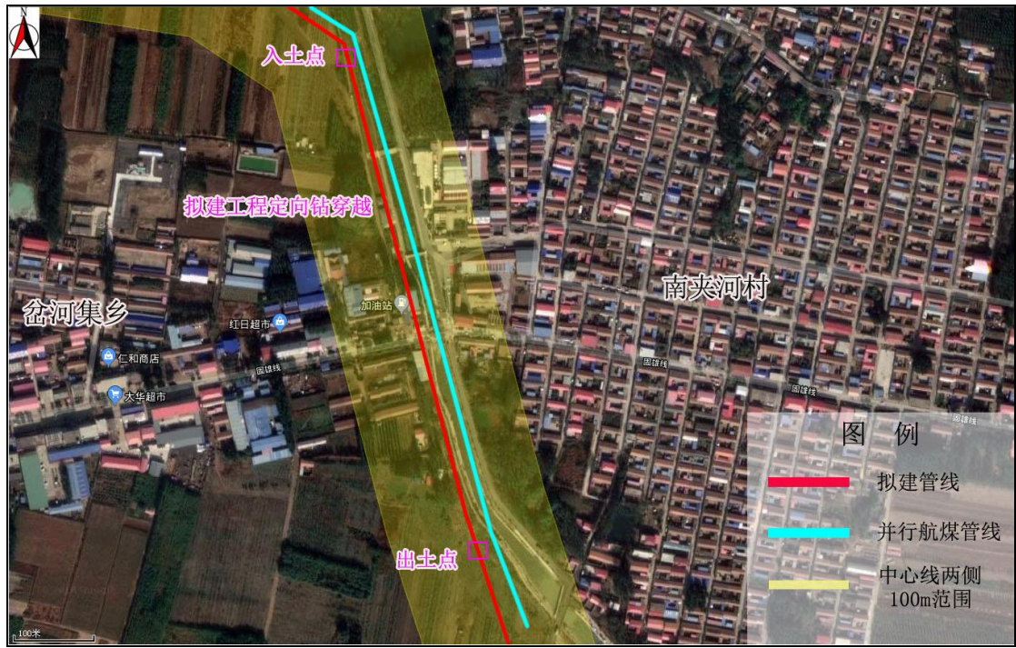
图 3.4-3 霸州市岔河集村与南夹河村定向钻穿越段示意图
