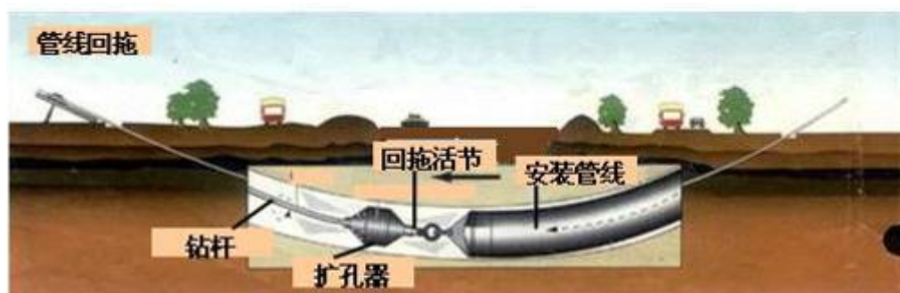
图 4.1-7 管线回拖示意图
