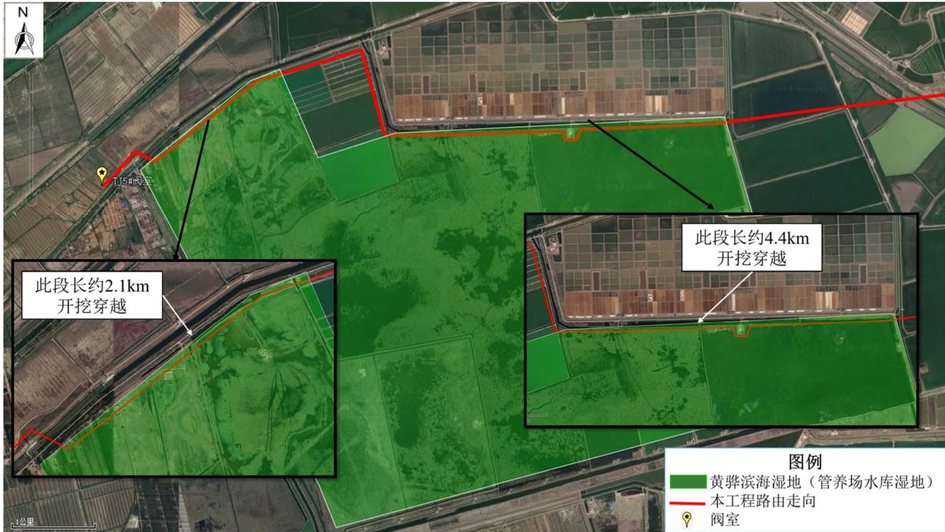
图14.1-3 本工程管道路由穿越黄骅滨海湿地（管养场水库湿地）的位置关系图
