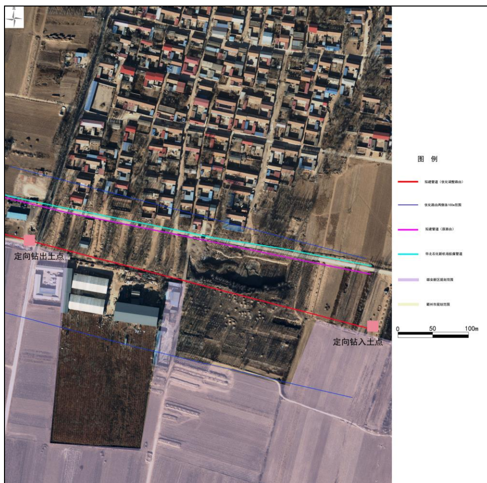
图 3.4-3 前狄庄村定向钻穿越段示意图
