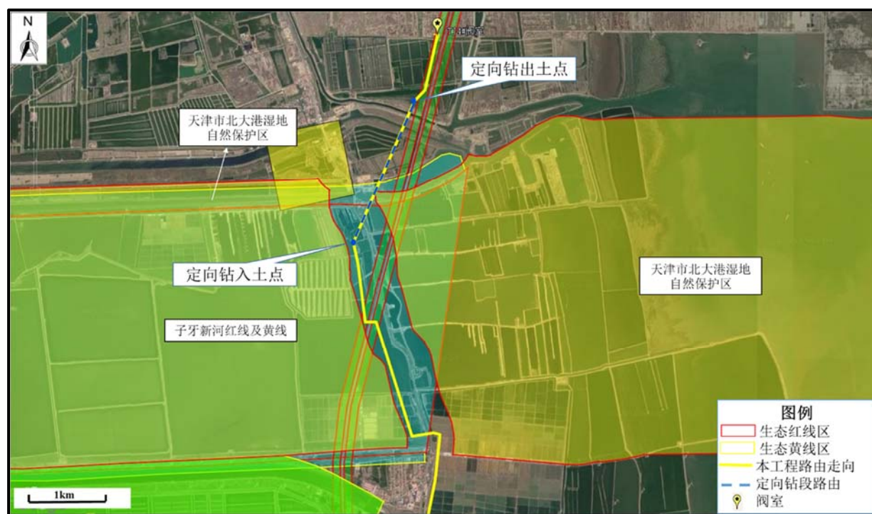
图14.1-16 管道穿越天津市永久性保护生态区域示意图
