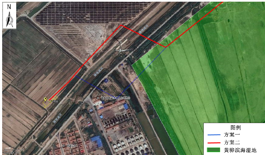
图 6.1-5 本工程天津联络线 5# 闸室段路由比选示意图
