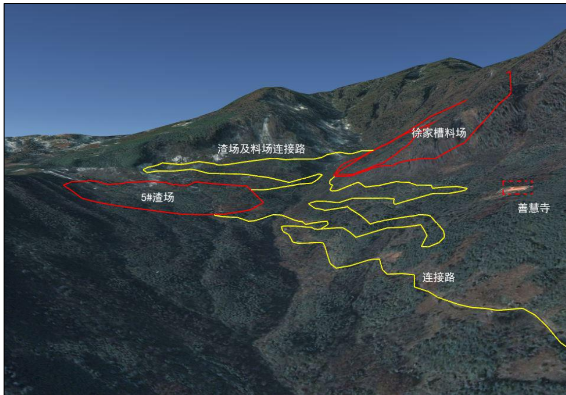
图 3.9-3 徐家槽料场对外连接路布置情况图
