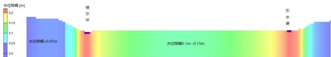
图 5.5.1-3 运行期河谷平原地下水位下降幅度
