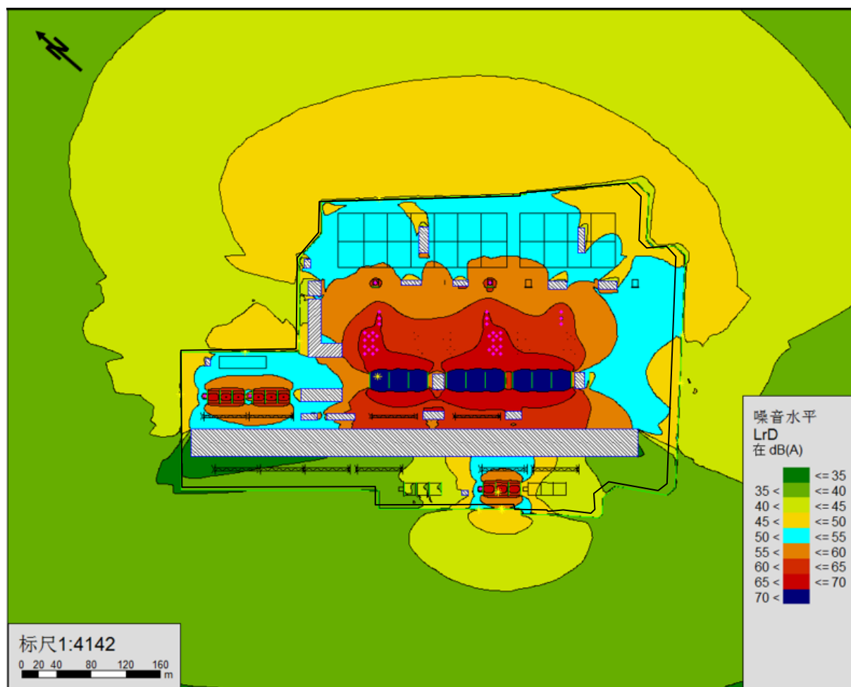
图 6.2-7 本期扩建后胜利站全厂主要设备噪声源的噪声预测值等声级线预测图
