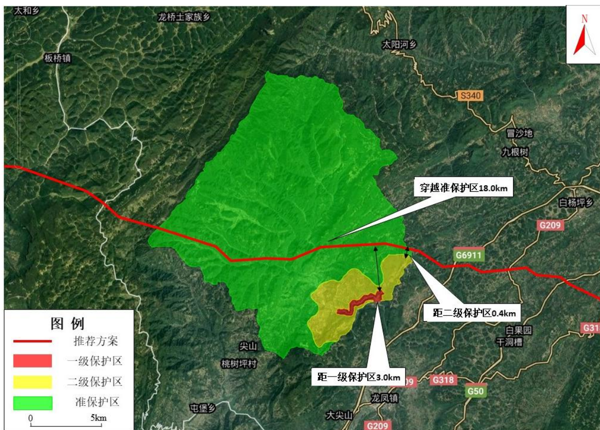
图 3-80 本工程线路与湖北省恩施州恩施市喻家河水库水源保护区位置关系示意图
