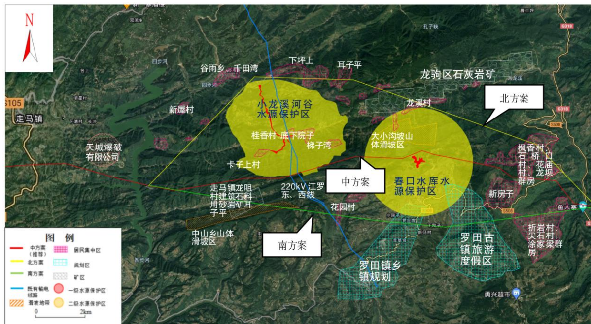
图 3-77 本工程穿越小龙溪河谷雨自来水厂水源保护区、春口水库马头村自来水厂水源保护区周边形势图
