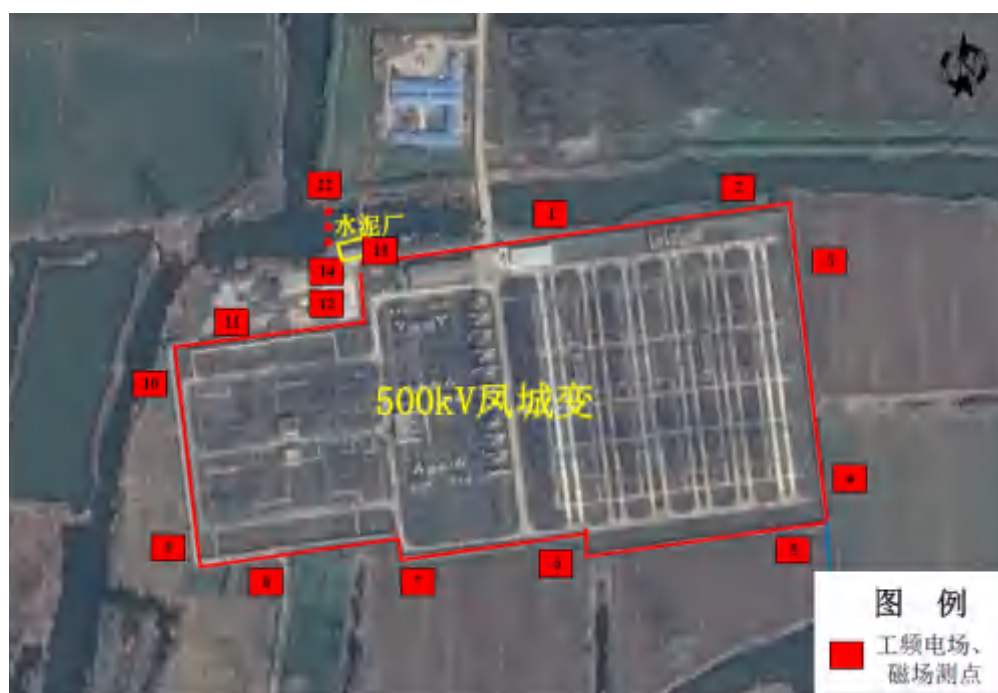
图 6.1-2 凤城 500kV 变电站类比监测布点图
