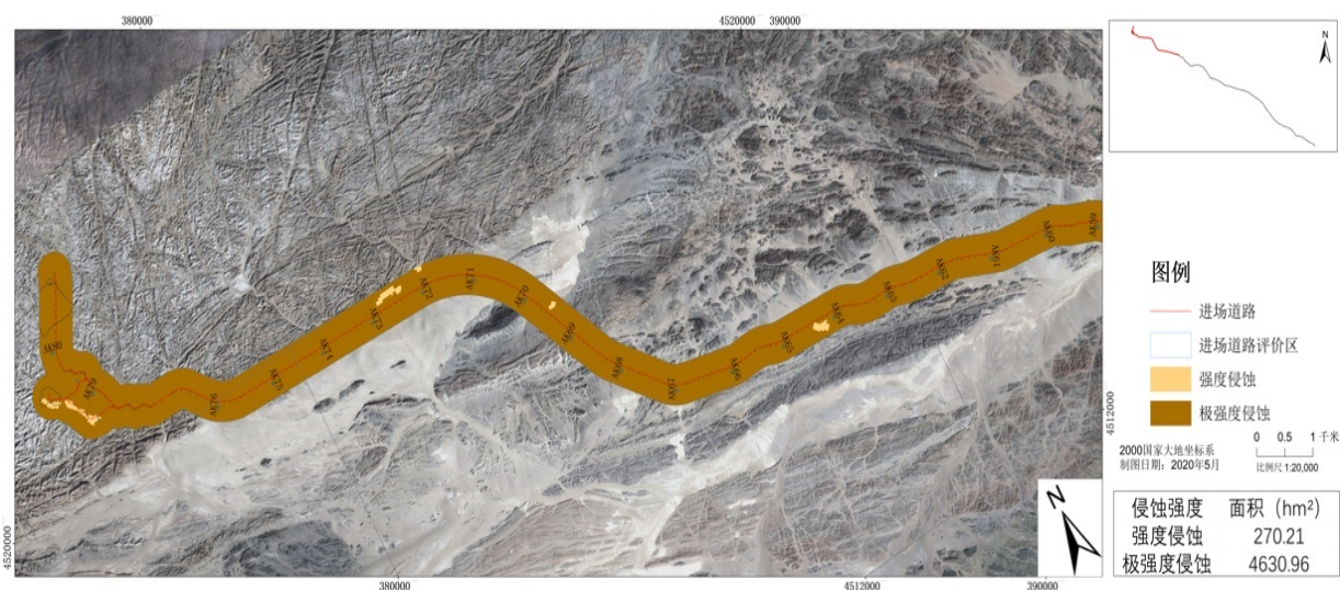
图 5.4-15 (1) 进场道路（路段 1）附近土壤侵蚀情况
