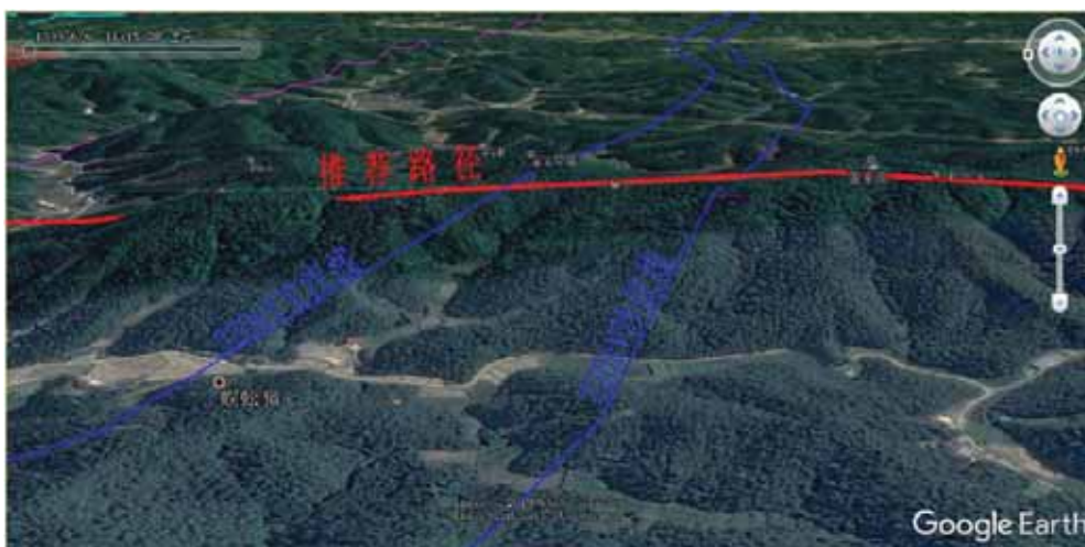
图 3-14 推荐方案跨越电力线路方案图（利用南北方向山脊利于跨越）
