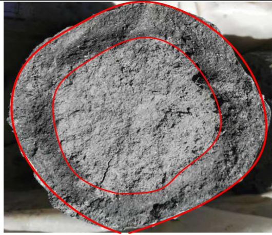
照片1 膨润土泥浆在岩心表层形成的保护层
