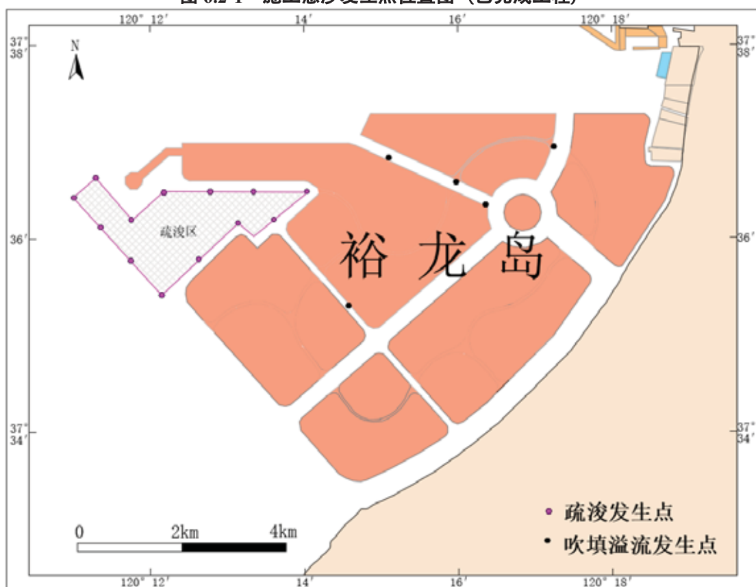
图 6.2-2 施工悬沙发生点位置图 (后续工程)
