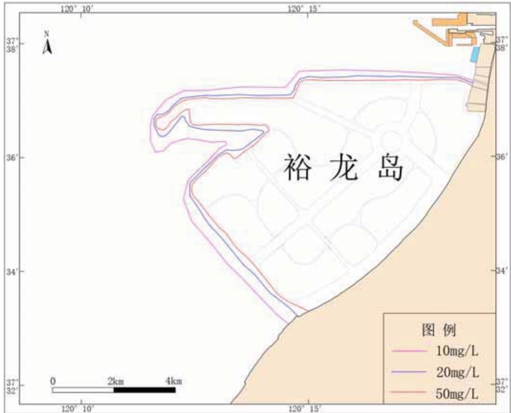
图 6.2-3 块石抛填悬浮泥沙扩散范围图
