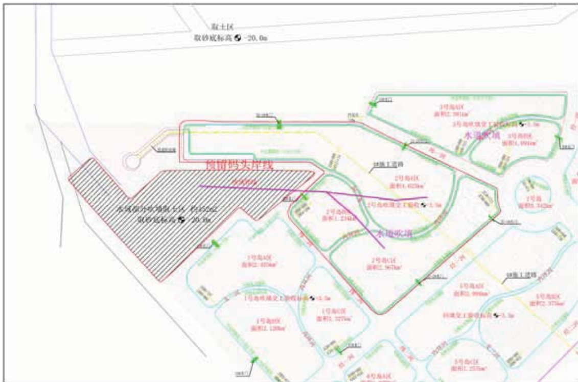
图 2.5-1 吹填取土区位置及吹填管线布置示意图
