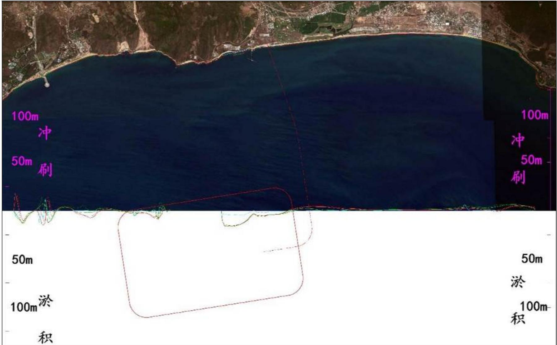
图 6.4-3 方案二实施后经历海燕台风过程的岸线冲淤变化
