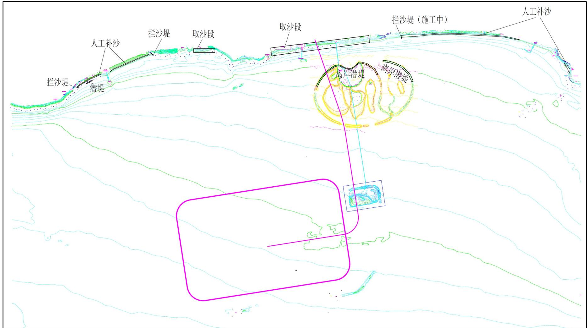
图 9.4-15 不同岸段岸滩冲淤防护措施总体布置图
