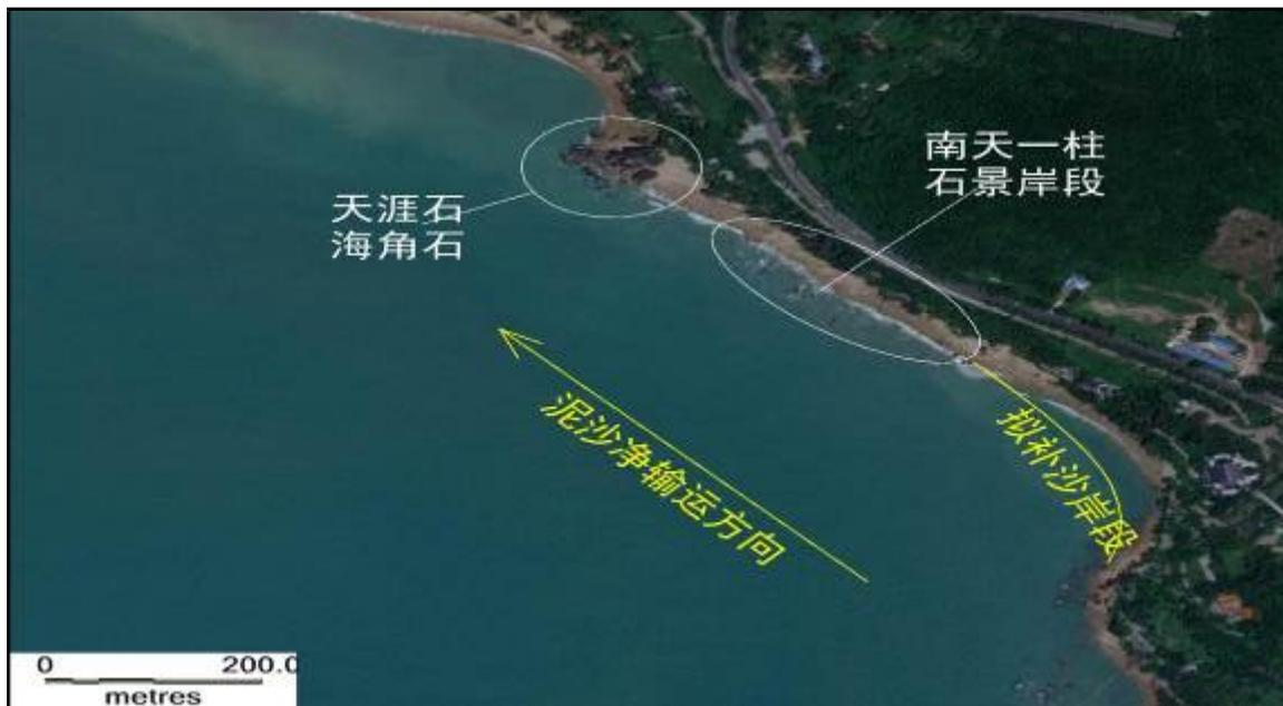
图 9-4-1 天涯海角附近人工补沙岸段示意图
