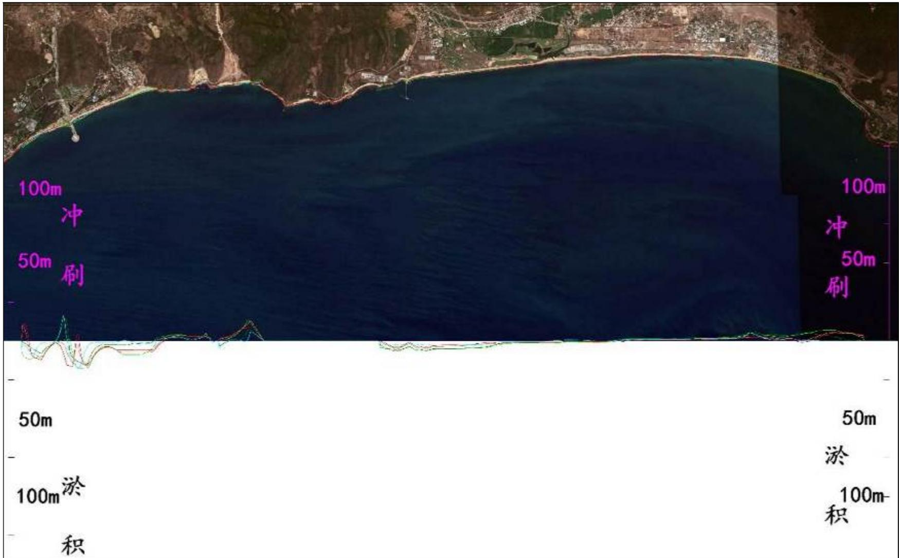
图 6.4-2 工程前经历海燕台风过程的岸线冲淤变化
