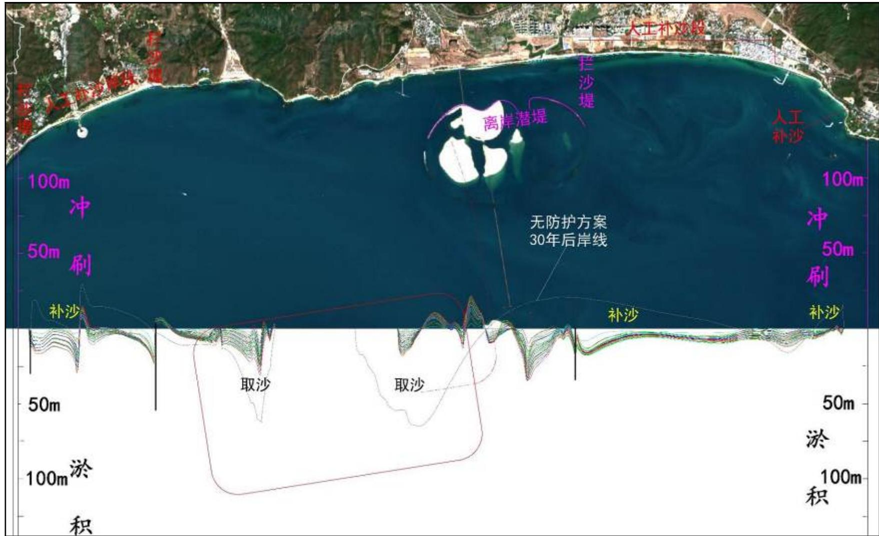
图 9.4-16 岸滩冲淤防护措施实施后 30 年内的岸线演变模拟结果
