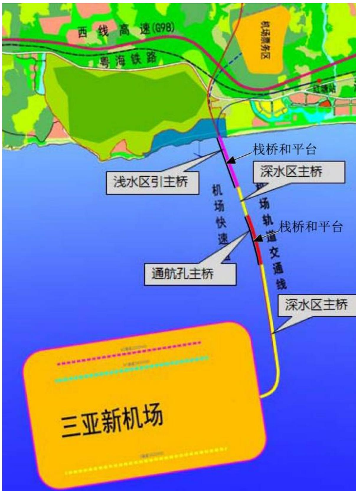
图 4.2-23 连岛大桥跨海段施工分区示意图
