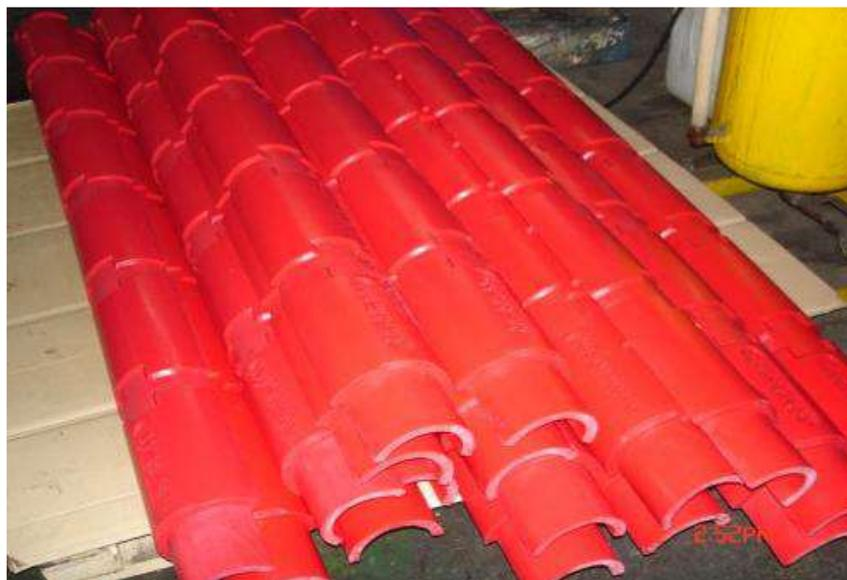
图 2.4-3 聚氨酯保护套管
