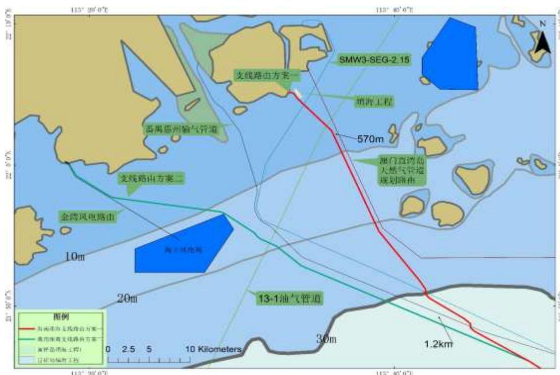
图 4.4-8 支线路由海域已建（拟建）光缆、管道分布图
