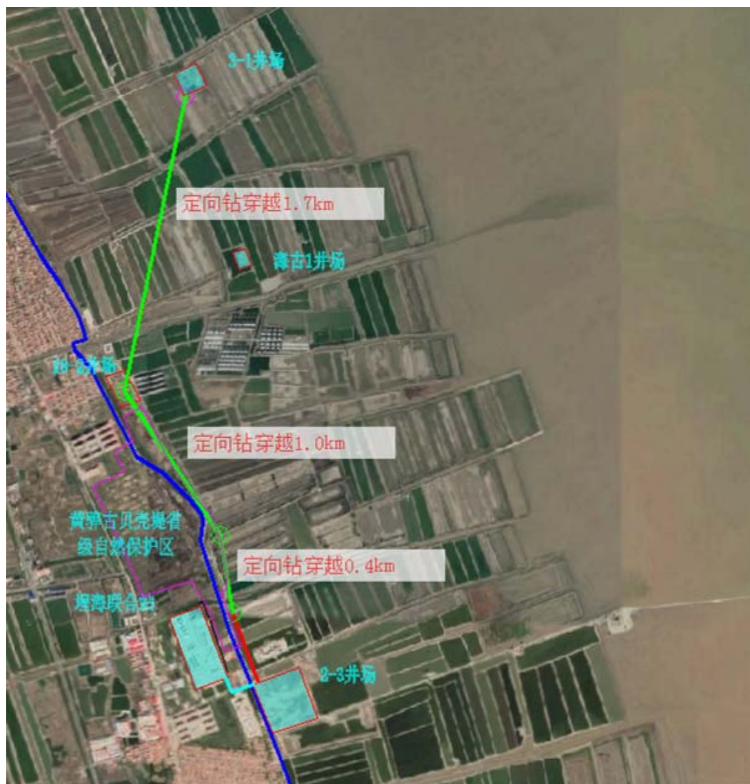
图 2.2-2 本工程方案 1 路由平面布置图
