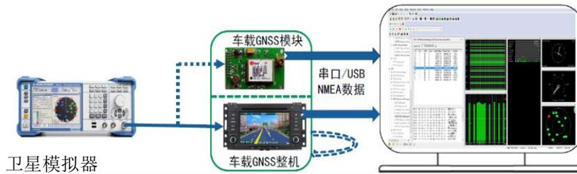
图 A.1 仿真测试示意图
