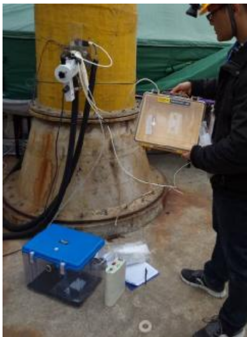
图 14 采用气袋法采样系统在现场进行实际样品检测
