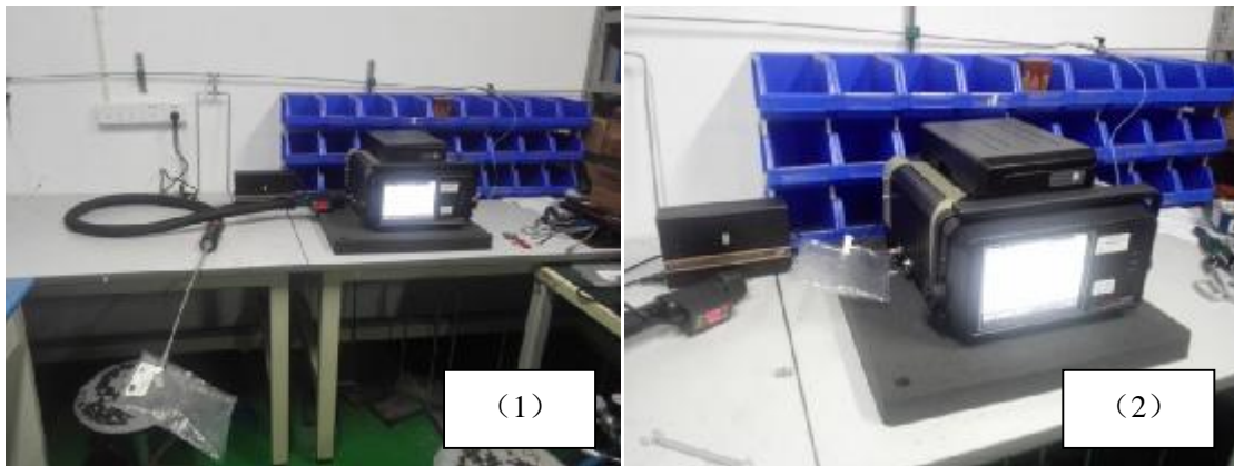
图注：（1）气体样品通过加热采样管进入便携式GC-MS分析；（2）气体样品直接进入便携式GC-MS分析
