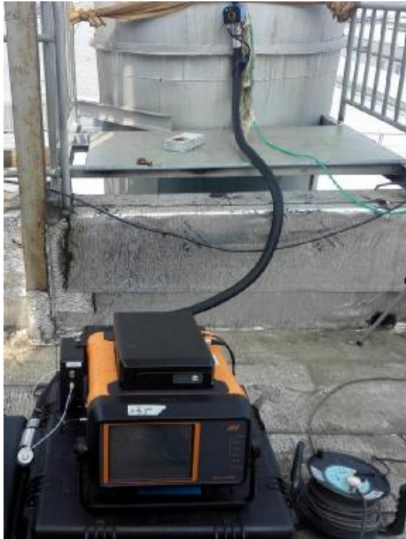
图 16 仪器直接进样法采样系统在现场进行实际样品检测
