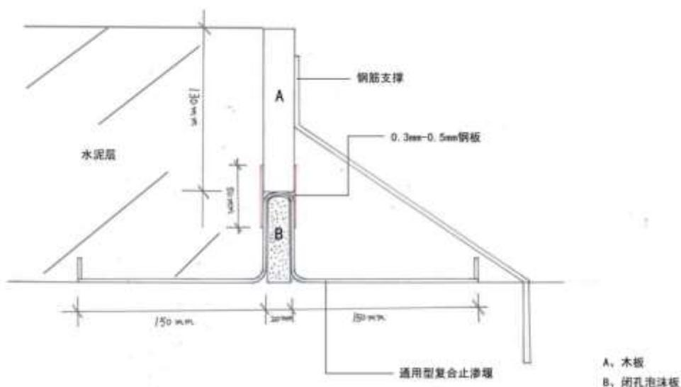
图 B.1 典型地面施工缝施工示意图
