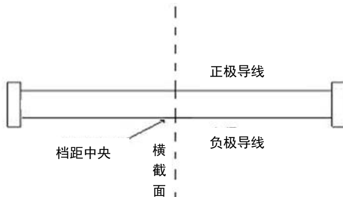
图1 直流架空输电线路下方地面合成电场监测布点图
