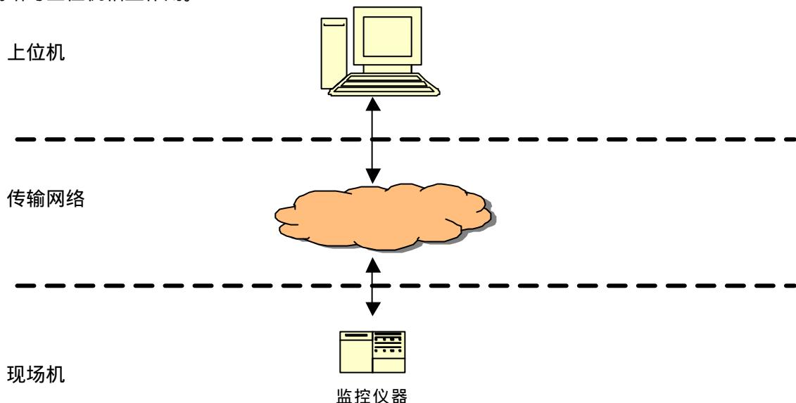
2) 现场有一套或多套监控仪器、仪表，监控仪器、仪表具有模拟或数字输出接口，挂接于独立的数据采集传输仪，上位机通过数据采集传输仪实现数据交换和收发指令。
