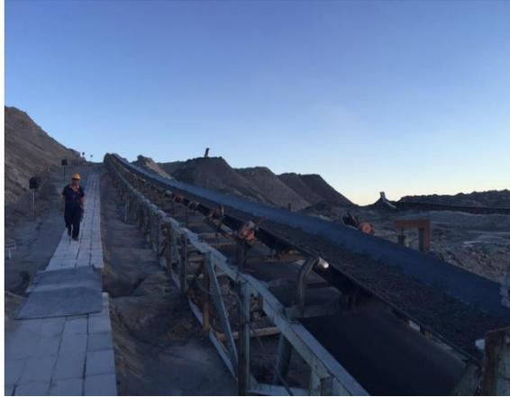
图 5.12 氰渣输送皮带
