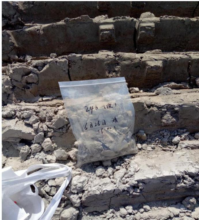
图 5.9 西北干旱地区某典型黄金氰化生产企业氰渣自然降解试验现场取样
