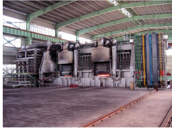
图10 倾动式精炼炉
