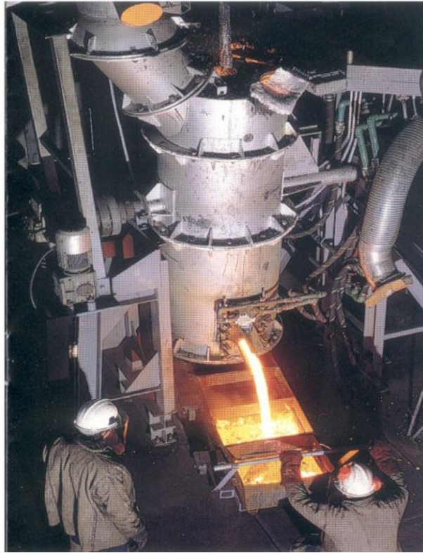
图7 顶吹浸没式喷枪熔炼炉
