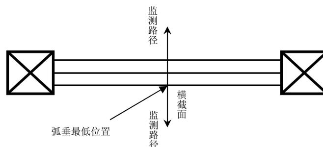
图 1 架空输电线路下方工频电场和磁场监测布点图
