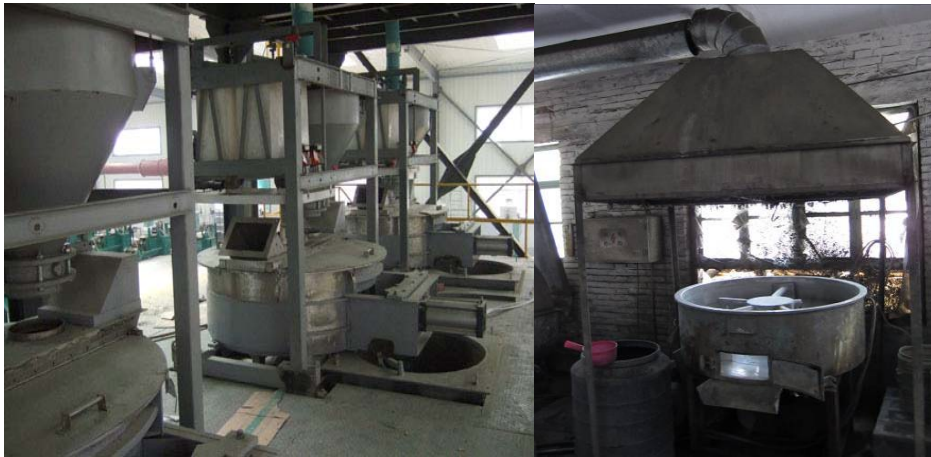
图 5 先进与落后的和膏工序对比
