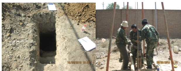
附图 1.1 常用的钻探方法示例照片（探坑法钢索冲击钻探法）
